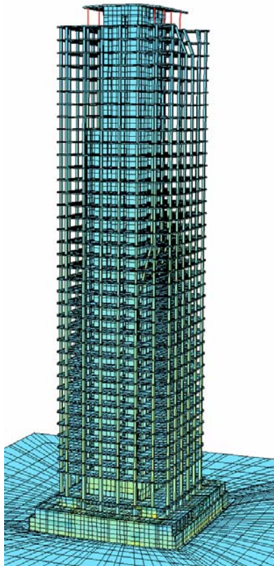
Computer-Gesamtmodell incl. Baugrund (Halbraum)
